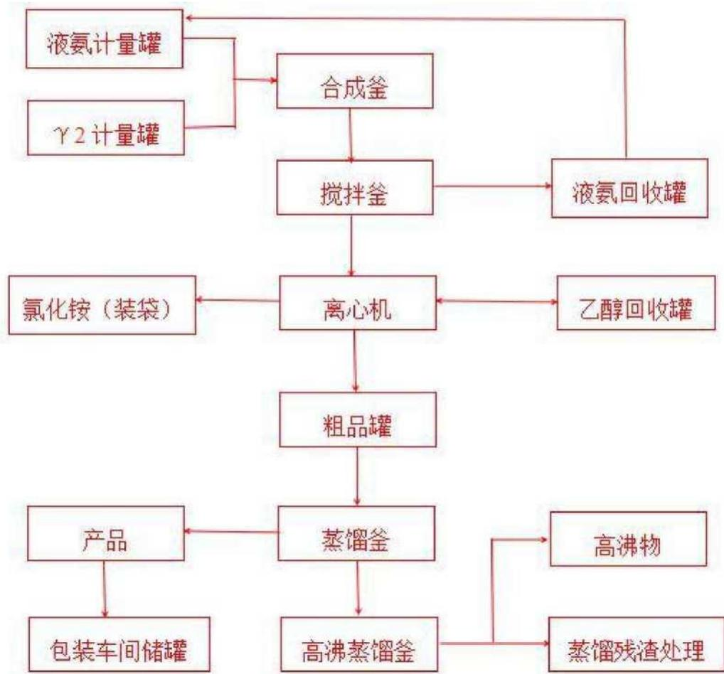
图 2.1-2 KH-550 工艺流程框图
