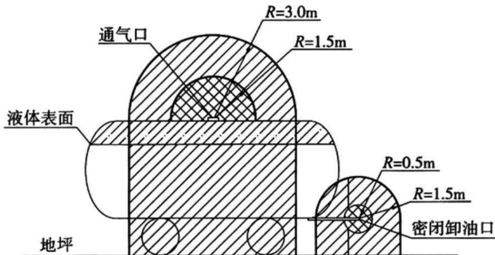
图 C.0.4 汽油油罐车的爆炸危险区域划分
