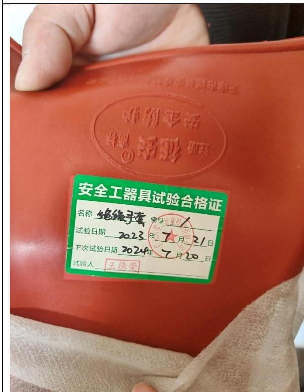
图 2-36 绝缘手套
